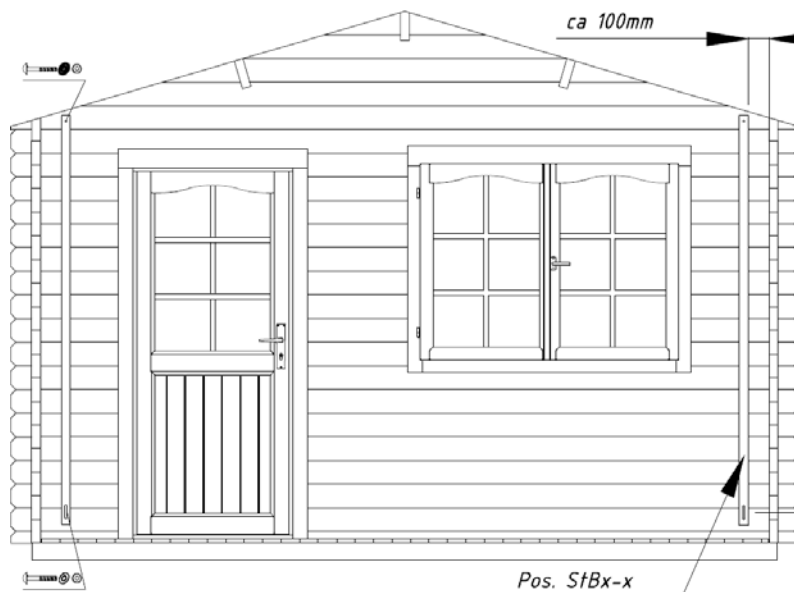
Montage des contreventements:
