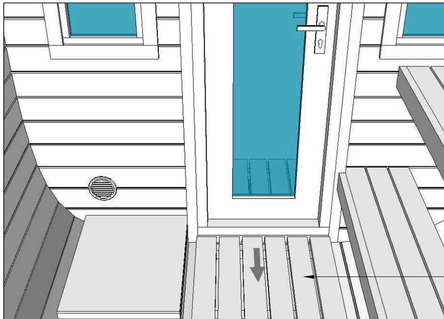
DET 12 ist installiert ohne Schrauben, damit der Boden gereinigt werden kann
